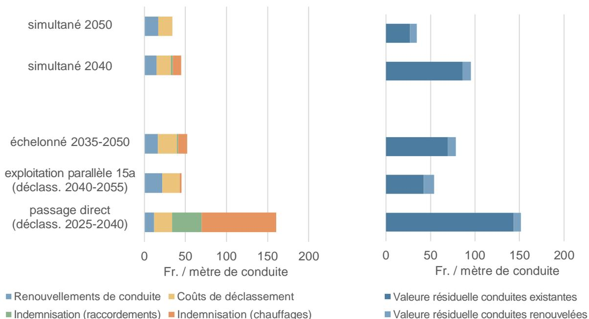
Figure ii : Coûts avec incidence sur les liquidités (à gauche) et investissements échoués au moment du déclasserement (à droite) dans différentes options considérées dans le quartier A (annonce du déclasserement en 2025 dans toutes les options)
